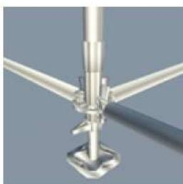
**(4)** Na sequência os postes devem ser encaixados nas bases começando então a verticalizar a estrutura.
